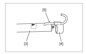
6 Insérez le capuchon de tube [4] dans le tube de protection de l'arbre [3].
