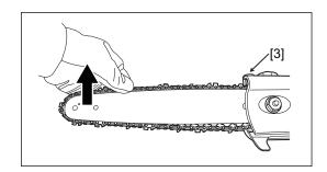
Tout en levant le guide-chaîne, serrez l'écrou de guide-chaîne [1] avec un outil.
