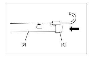
**7** Démontez la chaîne et le guide-chaîne, puis nettoyez le guide-chaîne. Frottez la saleté, etc. avec un chiffon.
