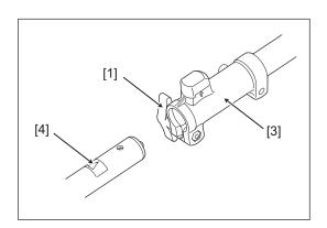
2 Alignez le bossage (protrusion) [2] à l'extrémité du tube avec la fente du carter de cardan [3], et insérez-le jusqu'à la position de l'étiquette [4].
