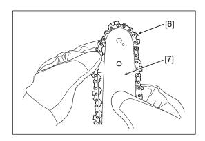
Tournez le boulon de tensionnement [3] dans le sens des aiguilles d'une montre jusqu'à ce que le jeu de la chaîne devienne faible.
