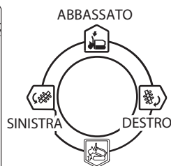
INTERRUTTORE DI COMANDO DELL'ALLOGGIAMENTO DELLA COCLEA
